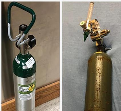
Figura 1: Cilindro E de oxígeno estándar (izquierda) y un cilindro de dióxido de carbono de apariencia similar (derecha).
