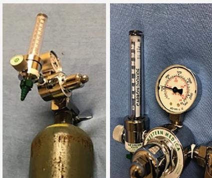
Figura 2: Medidores de flujo casi idénticos, pero uno tiene una pequeña etiqueta de dióxido de carbono (derecha).
