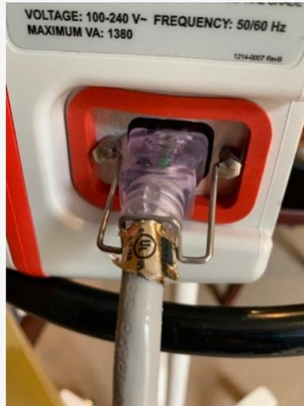
图 1: 显示通过安全门固定到位的三相接地插头，以防止电源线意外拔插。
