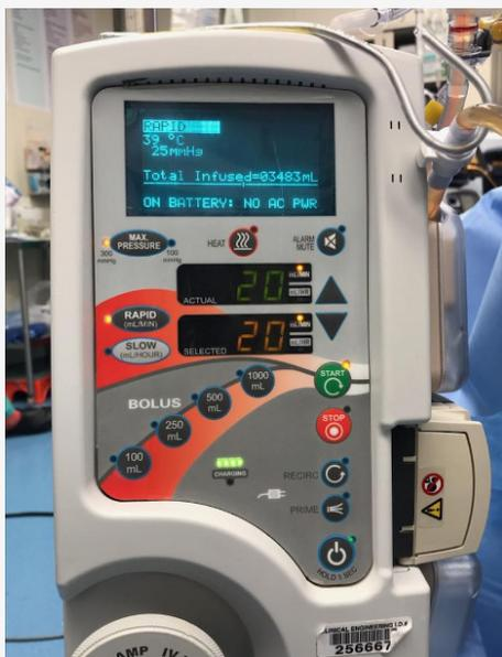
图 2: 在快速输液器断电以后，显示器屏幕不再出现“加热中”，取而代之的是“电池供电：没有交流电”，并闪烁显示“加热停止”。（注：图片是在发生实际临床事件以后获得的。）
