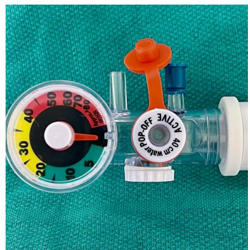
الشكل رقم 1: صور متعددة لجهاز فرط الانتفاخ SunMed Ventlab (مرجع HS4011, Ventlab, LLC, Grand Rapids, MI) مع مراعاة صمام الضغط القابل للضبط. يُرجى ملاحظة صعوبة قراءة النص المكتوب بالخط الأبيض على البلاستيك الأبيض. تمت كتابة كلمة "فتح" على السهم في اتجاه عقارب الساعة وهو عكس ما هو متوقع عادةً (حيث يؤدي الدوران في اتجاه عقارب الساعة عادةً إلى إغلاق الصمام).
