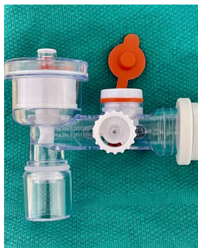
الشكل رقم 1: صور متعددة لجهاز فرط الانتفاخ SunMed Ventlab (مرجع HS4011, Ventlab, LLC, Grand Rapids, MI) مع مراعاة صمام الضغط القابل للضبط. يُرجى ملاحظة صعوبة قراءة النص المكتوب بالخط الأبيض على البلاستيك الأبيض. تمت كتابة كلمة "فتح" على السهم في اتجاه عقارب الساعة وهو عكس ما هو متوقع عادةً (حيث يؤدي الدوران في اتجاه عقارب الساعة عادةً إلى إغلاق الصمام).
