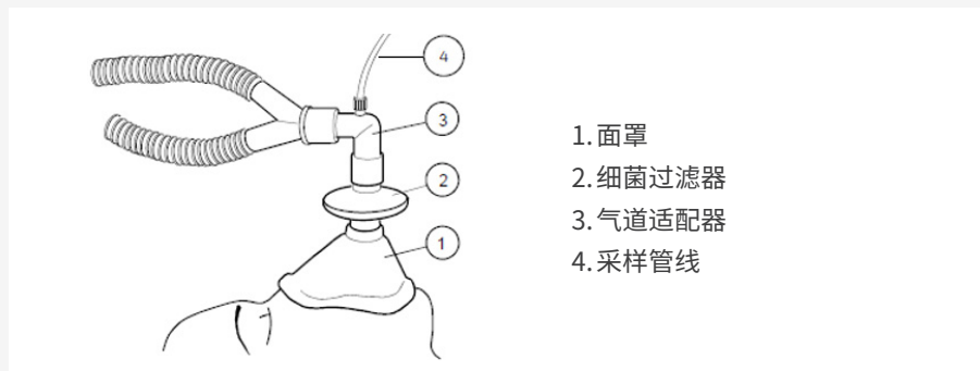
图6-面罩通气过程中的气体测量设置。
