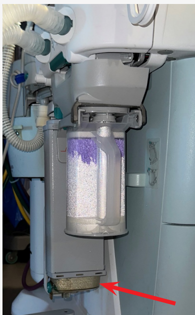
图 2: Avance CS 2 上冷凝器储液罐的位置。
